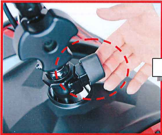
拉起把手定位鈕，將 T 把轉向機構鎖住。
