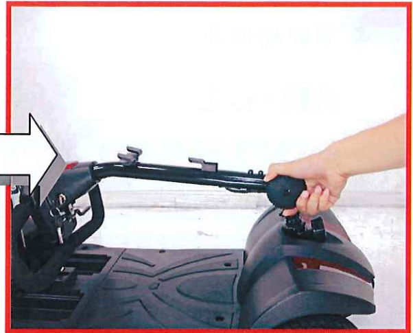
放鬆把手角度調整旋鈕，將把手折下後，再次鎖緊
