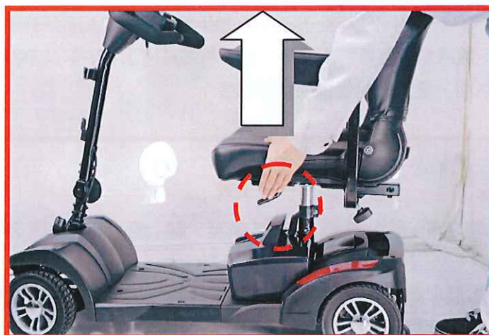
拉著座椅旋轉拉柄並將座椅往上抽離座椅撐管
