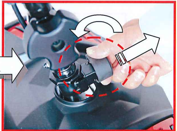
拉起把手定位鈕，將 T 把轉向機構鎖住。
