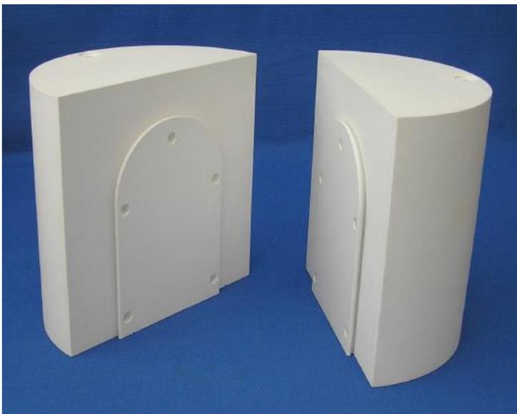
兩個側向散射體可使立方體假體完整成為模擬人形之形狀。這些散射體可安裝在立方體各面之處，使軟片得以維持橫向、矢狀或冠狀之幾何。組合件的寬度為 36 cm。
