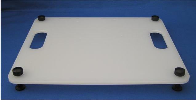
組裝完的人體假體以螺絲鎖在基板上，將提供額外的穩固力。此有助抬升與運送假體，並於各角落提供平衡機制為了在 CT 或直線加速器下操作時能正確校準假體。
